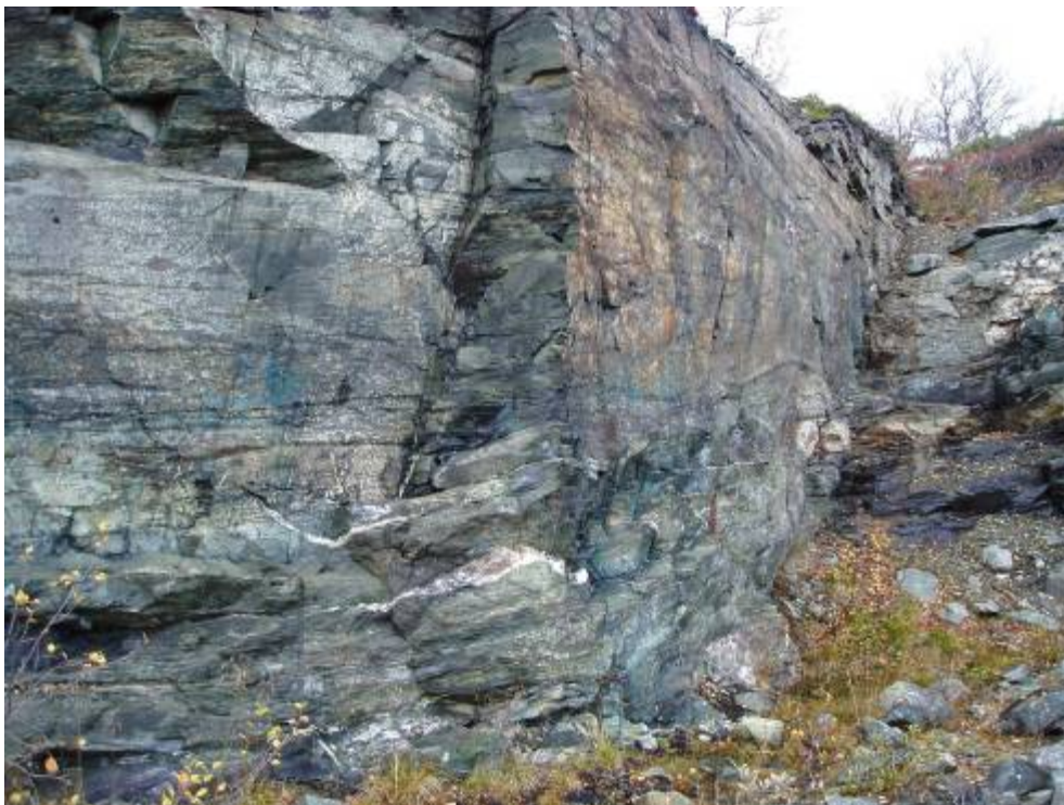
Bild 7. Bergvägg med spår av två olika brytningsmetoder. Övre delen av bergväggen är tämligen slät och saknar borrhål. Därunder är bergväggen skrovlig och har borrhål. Den nedre delen är krutsprängd. Den övre är antingen tillmakad eller ett resultat av kilning. Bilden tagen mot norr i nr 24e enligt fig. 3. Foto: L. Klang.
